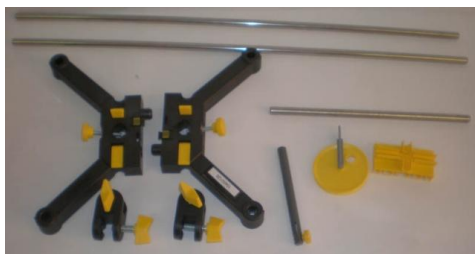
Рис. 9. Набір деталей і вузлів для складання лабораторного штатива
