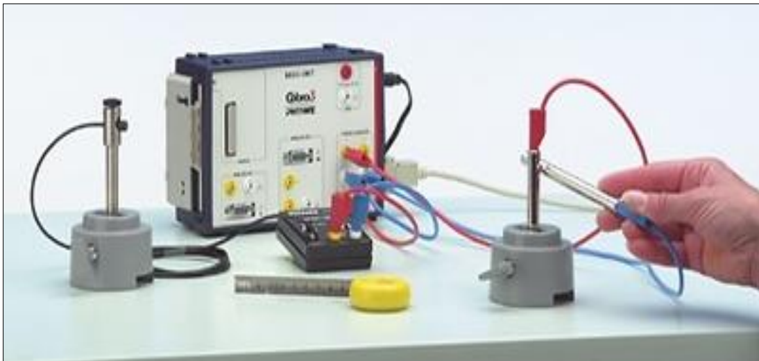
Рис. 16. Загальний вигляд установки для вимірювання швидкості звуку в повітрі.
