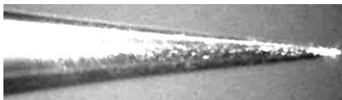
Рис.2. Зонд, полученный травлением в капле
