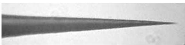
Рис.6. Зонд, полученный с автоматической отсечкой тока
