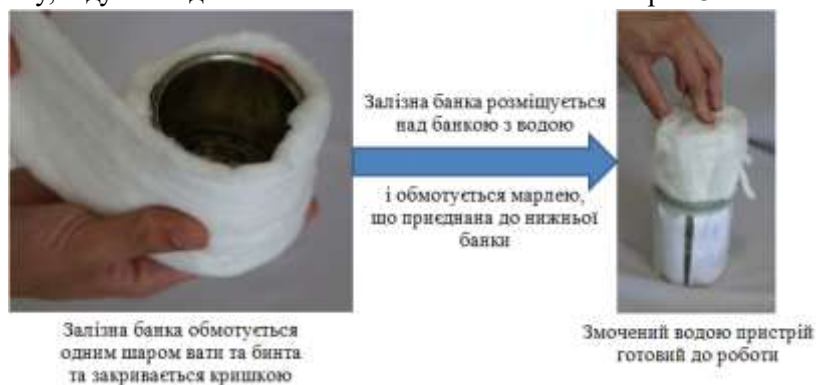
Рис. 3. Технологія виготовлення вдосконаленого холодильника типу «горщик у горщику»
