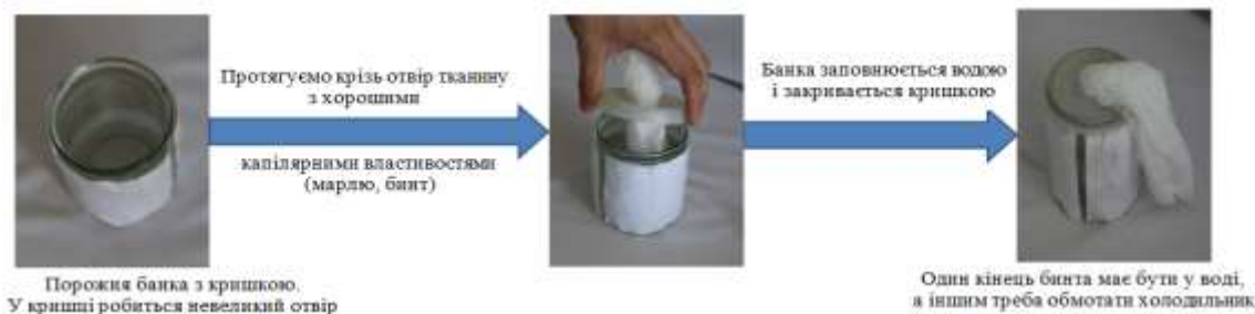
Рис. 2. Система подачі води до пристрою типу «горщик у горщику»
